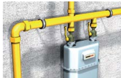
Крепление газовых расходомеров
