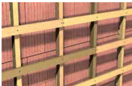
Крепление фасадных подконструкций
